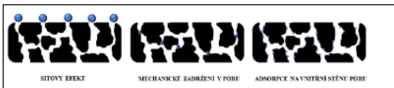
Obr. 1: Schéma mechanismů povrchové a hloubkové filtrace
