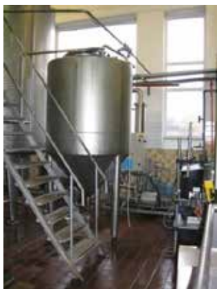
Provozní ultrafiltrační stanice (zásobní tank na surovinu a retentát, membránové jednotky)
